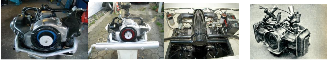
30 PS 697 ccm 1Vergaser 32PS 697 ccm 1Vergaser 40PS 697 ccm 2Vergaser Motor des BMW700 RS
