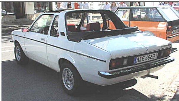
Aero , ein Umbau auf Basis der zweitürigen Limousine in ein offenes Fahrzeug durch den Baur Karosserie- und Fahrzeugbau aus Stuttgart, Bauzeit: 05.1976–06.1978
