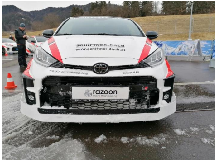
Rutsch- und Stoßplatte deutlich sichtbar, Schneehaufen erwischt, Plastik Kühlergrill wurde demoliert
